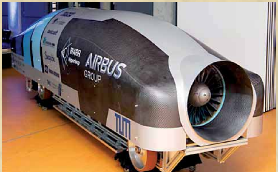
Hyperloop-Fahrzeug-Prototyp, gebaut von der Technischen Universität München, aus gerüstet mit Hochleistungs-PU-Radreifen von ASMA.
