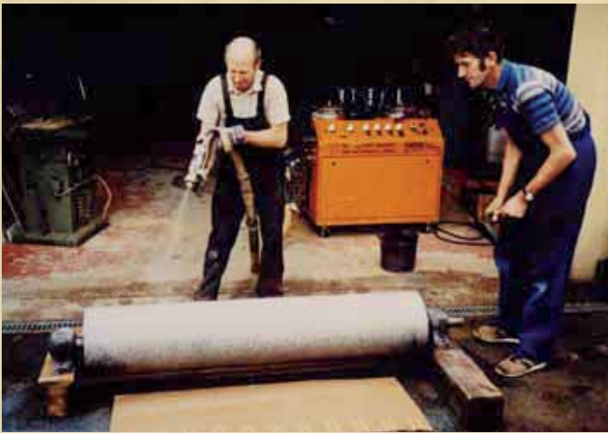
Max Aspelmayr mit einem Mitarbeiter bei der Sprühbeschichtung einer Walze. Foto: ASMA
