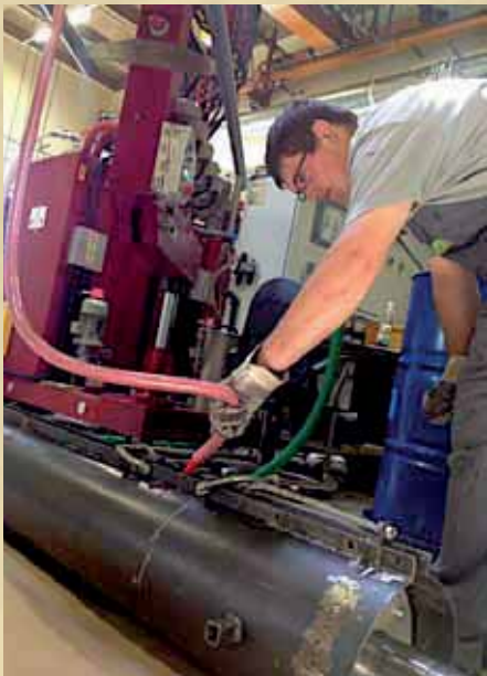
Das Gießen von Walzenbeschichtungen (links) erfordert wie viele andere Gießjobs handwerkliches Geschick und Konzentration. Die PU-Beschichtungen werden nach dem Gießen auf Drehmaschinen für einen perfekten Rundlauf nachbearbeitet. Foto: ASMA
