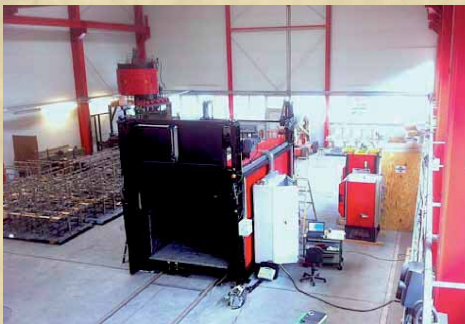
Groß-Wärmeofen zum Nachheizen von Großwalzen und anderen Groß-Bauteilen.
