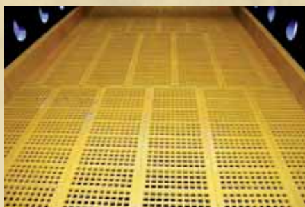
Siebe aus Guss-Polyurethan bieten gegenüber Stahlsieben eine längere Standzeit, Selbstreinigung durch die fluktuierende Durchbiegung und der dadurch hervorgerufenen Spreizung der konischen Durchgangsöffnungen auf, sowie eine reduzierte Lärmemission.
