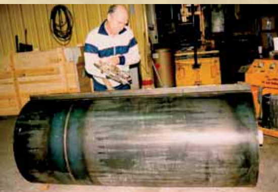
Max Aspelmayr beim Füllen einer Gießform zur Walzenbeschichtung, darunter die entformte Walze mit dem Angusssteg, ganz unten zur Nachbearbeitung auf der Drehmaschine.
