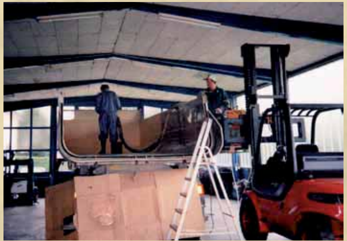
Mobile Beschichtung von Verschleißflächen am Beispiel einer LKW-Ladefläche. Foto: ASMA
