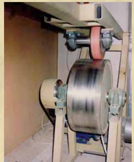
Die Standzeit von Radreifen, hier am Beispiel eines Aufzugs-Führungsrades, wird zur Ermittlung der best-geeigneten Rezeptur auf einem eigenen Prüfstand ermittelt. Foto: ASMA
