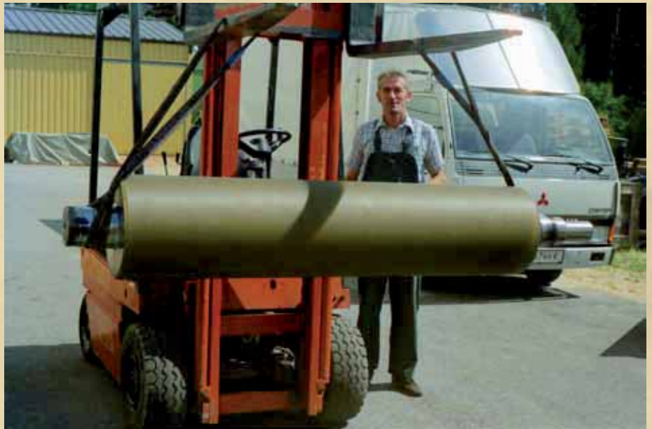
Das Gießen von Walzenbeschichtungen (links) erfordert wie viele andere Gießjobs handwerkliches Geschick und Konzentration. Die PU-Beschichtungen werden nach dem Gießen auf Drehmaschinen für einen perfekten Rundlauf nachbearbeitet. Foto: ASMA
