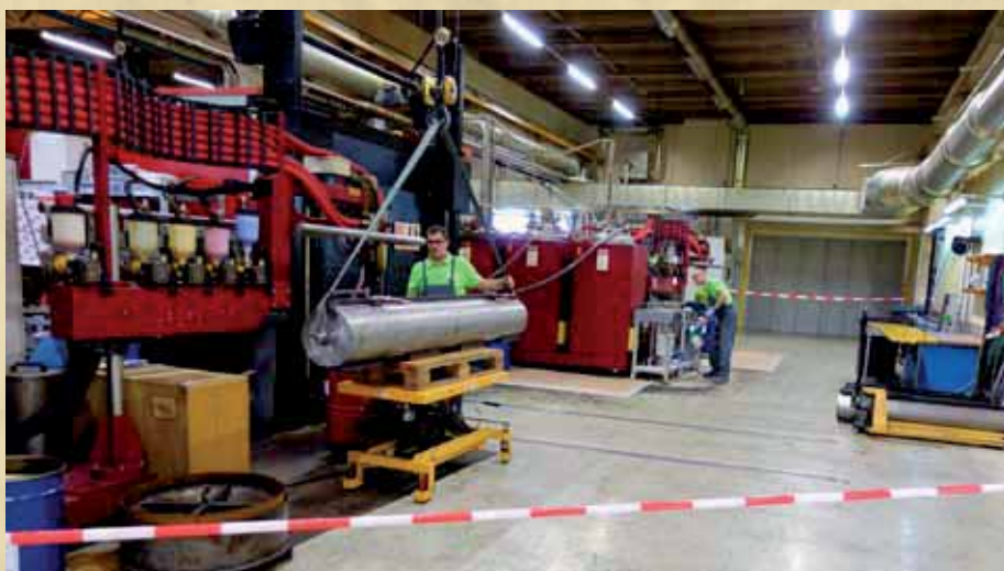
Blick in die ASMA-Produktion mit Gießanlagen zur Herstellung von Walzenbeschichtungen.
