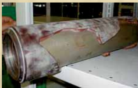
Versagen einer Walzenbeschichtung durch Hydrolyse in Kombination mit mechanischer Belastung. Die Hydrolyse bewirkt einen Kettenabbau der Polyester-moleküle, bis sie der mechanischen Belastung nicht mehr standhalten können.
